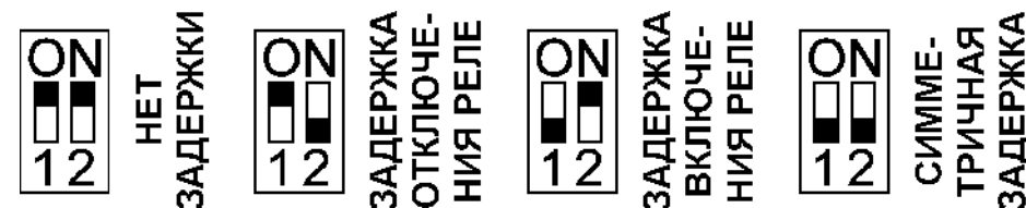
Рис. 5. Внутренние переключатели сигнализатора.
